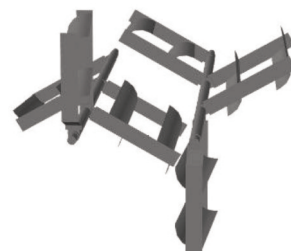
Рис. 3. Два вала с шахматным расположением мешалок творогоизготовителя РТ
