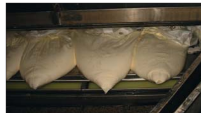
Рис. 9. Механизированная выгрузка фильтровальных мешков с творогом
