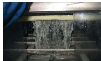
Рис. 6. Интенсивное отделение сыворотки при самопрессовании
