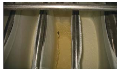
Рис. 8. Уплотнение слоя творожного сгустка при снятии нагрузки (на рисунке – центральный фильтровальный мешок)
