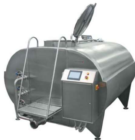
Рис. 2. Общий вид творогоизготовителя АРТ
