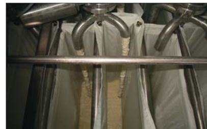
Рис. 4. Автоматизированный розлив творожного сгустка
