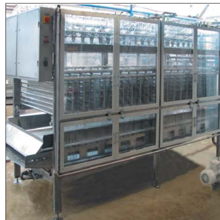
Рис. 6. Общий вид установки во время санитарной обработки наружного контура
