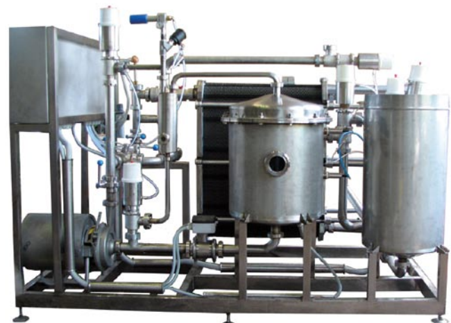
Рис. 4. Общий вид установки с вакуумным воздухоотделителем
